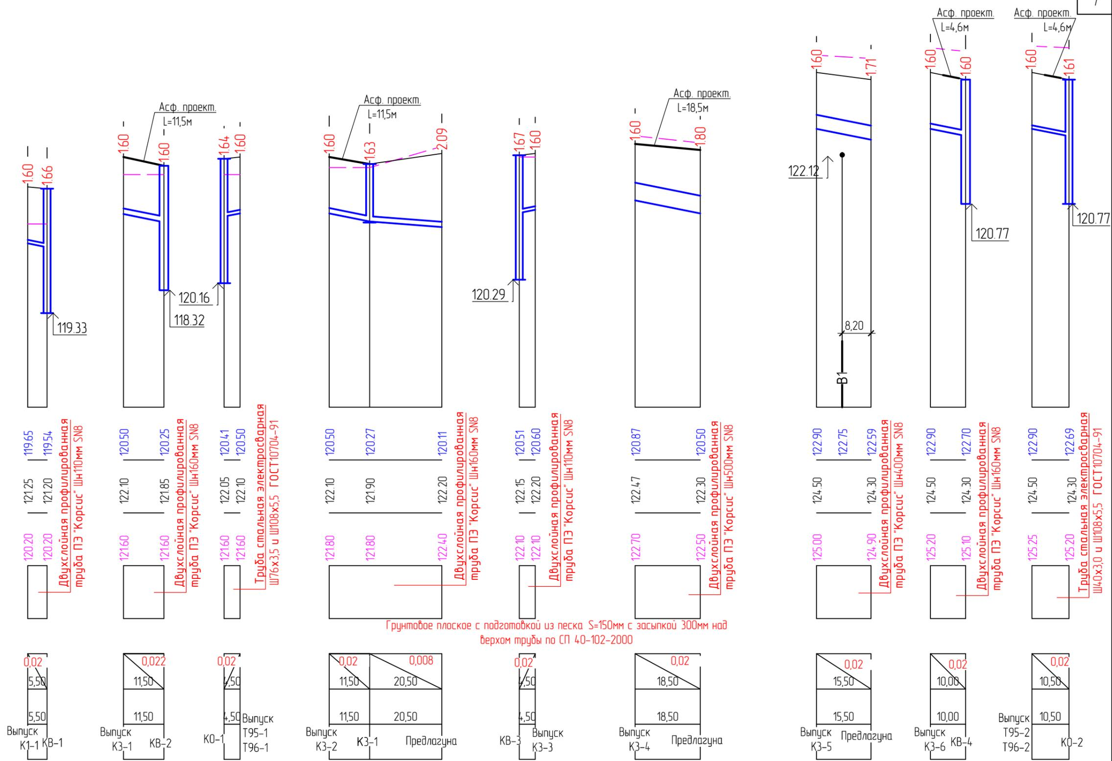
Грунтовое плоское с подготовкой из песка S=150мм с засыпкой 300мм над верхом трубы по СП 40-102-2000
